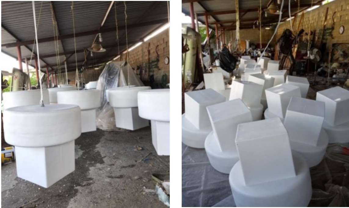
Figura 4. 19 Boyas rehabilitadas y fabricadas.
